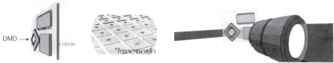
DMD ซึ่งเป็นอุปกรณ์ดิจิทัลประกอบด้วยกระจกขนาดเล็กจิ๋วจำนวนมากจะแปรข้อมูลที่อ่านจากโพสเซนเซอร์แล้วสะท้อนเพื่อสร้างภาพโดยผ่านกระบวนการกรองสีส่งไปยังเลนส์ฉาย ส่วนประกอบของเครื่องดีแอลพี
