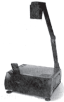
เครื่องแอลซีดีแบบตั้งโต๊ะบางรุ่นจะมีกล้องวิดีโอติดตั้งอยู่ด้านบนเพื่อถ่ายภาพสิ่งพิมพ์หรือวัสดุซึ่งวางอยู่บนด้านบนของเครื่องและส่งสัญญาณภาพผ่านเครื่องแอลซีดีฉายขึ้นจอภาพได้ทันที
