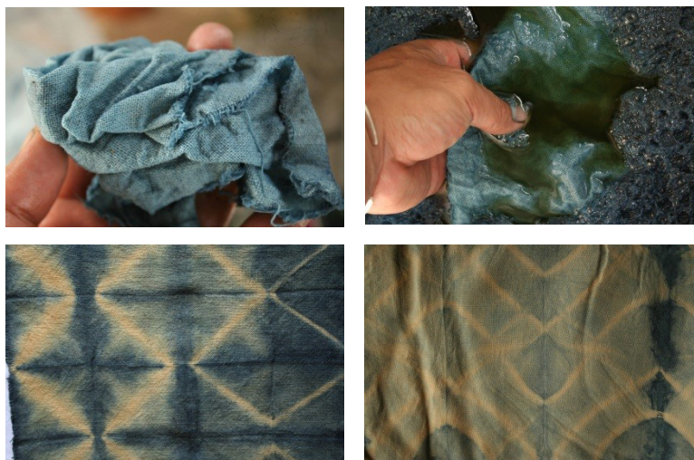
ภาพที่ 2 ผลการทดลองย้อมครามและสีธรรมชาติจากเปลือกต้นเพกา
